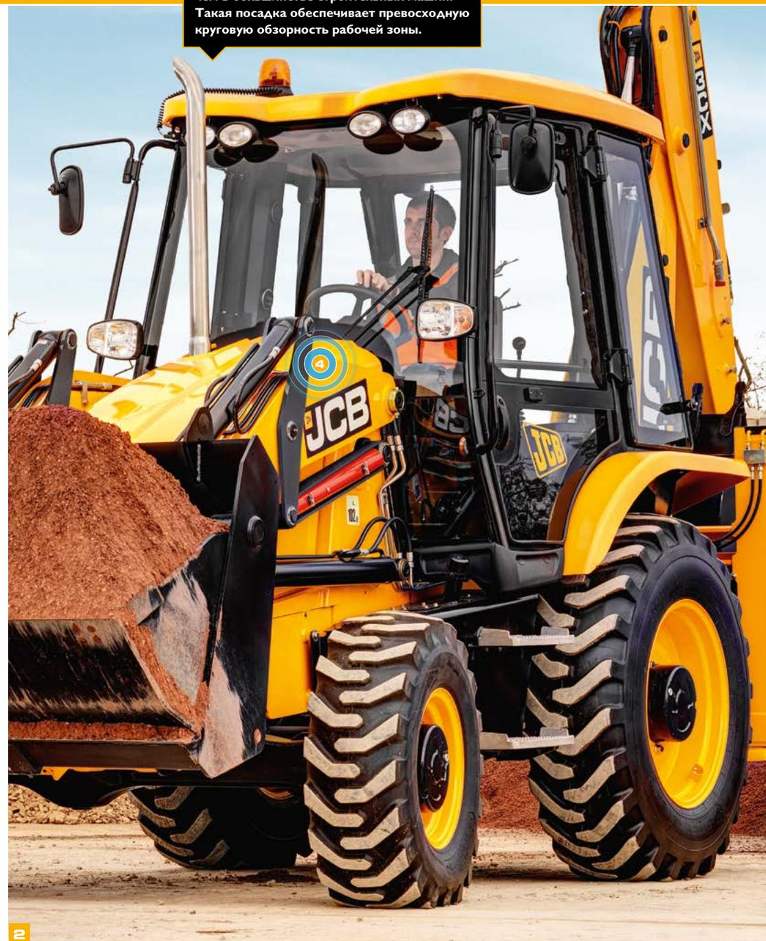
В JCB 3СХ оператор сидит выше, чем в большинстве строительных машин. Такая посадка обеспечивает превосходную круговую обзорность рабочей зоны.
