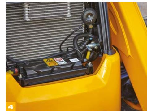
Дополнительная фильтрация топлива снижает загрязнение жидкостей и предотвращает засоры.
